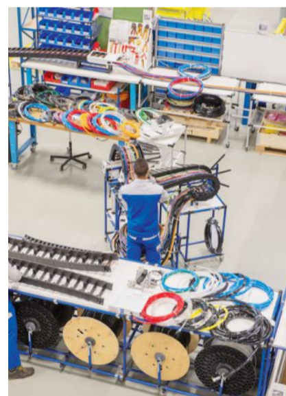
Farbenspiel bei der Vormontage der Kabelstränge.
